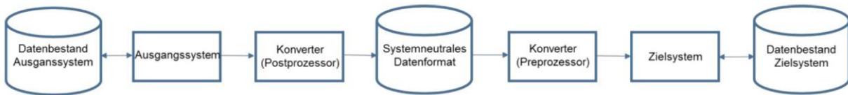
Abbildung 18 Datenkonvertierung mit Hilfe eines systemneutralen Datenformats nach (Vajna et al. 2009, S. 419)
